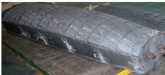
图6 铸铝基体表面燕尾槽
