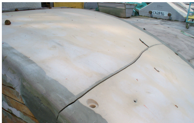
图1 木质基体拉形模基体、型面同时开裂
